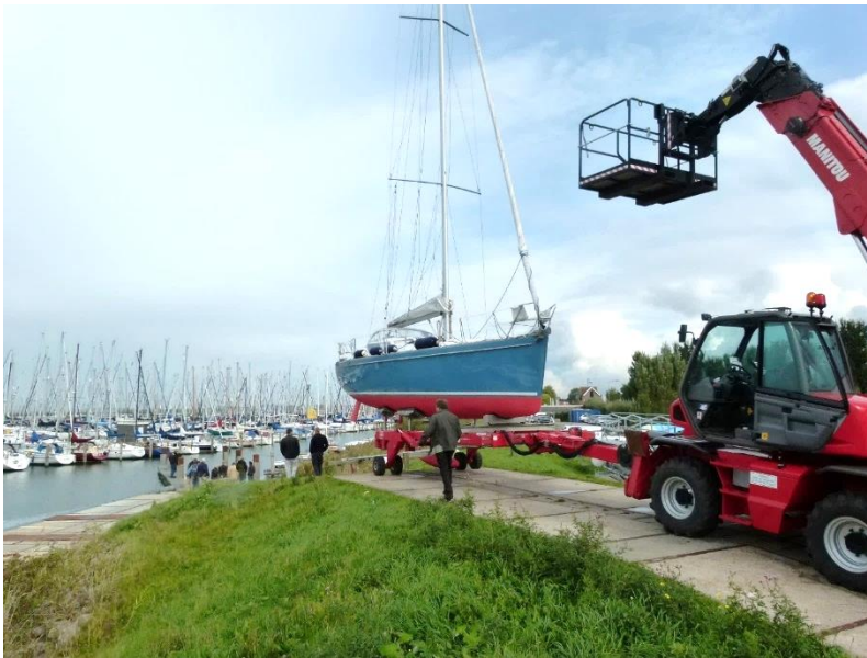
Botenwagen en hellingbaan over de primaire waterkering in Lelystad (Jachthaven Lelystad Haven)
